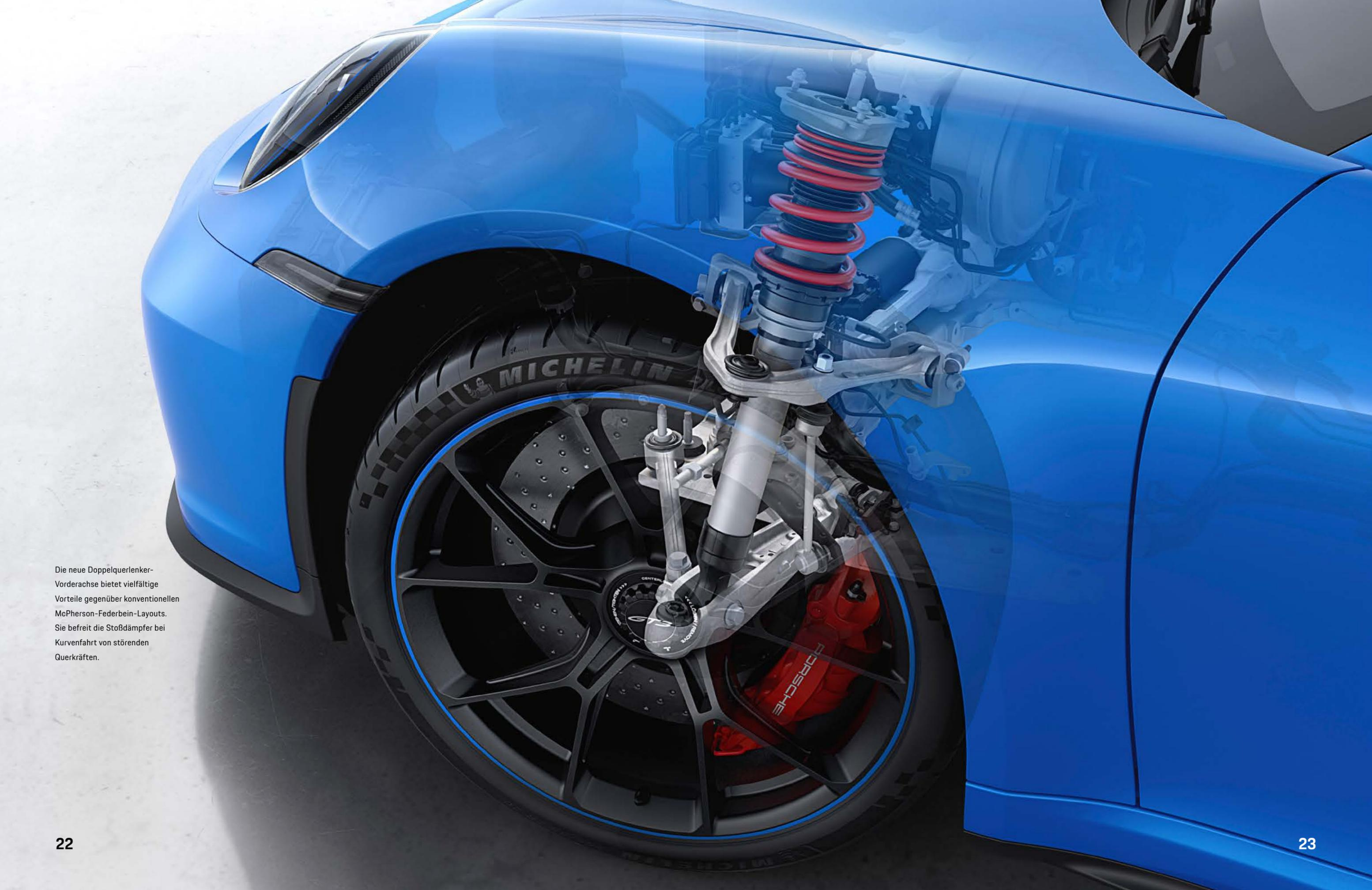
Die neue Doppelquerlenker-Vorderachse bietet vielfältige Vorteile gegenüber konventionellen McPherson-Federbein-Layouts. Sie befreit die Stoßdämpfer bei Kurvenfahrt von störenden Querkräften.
