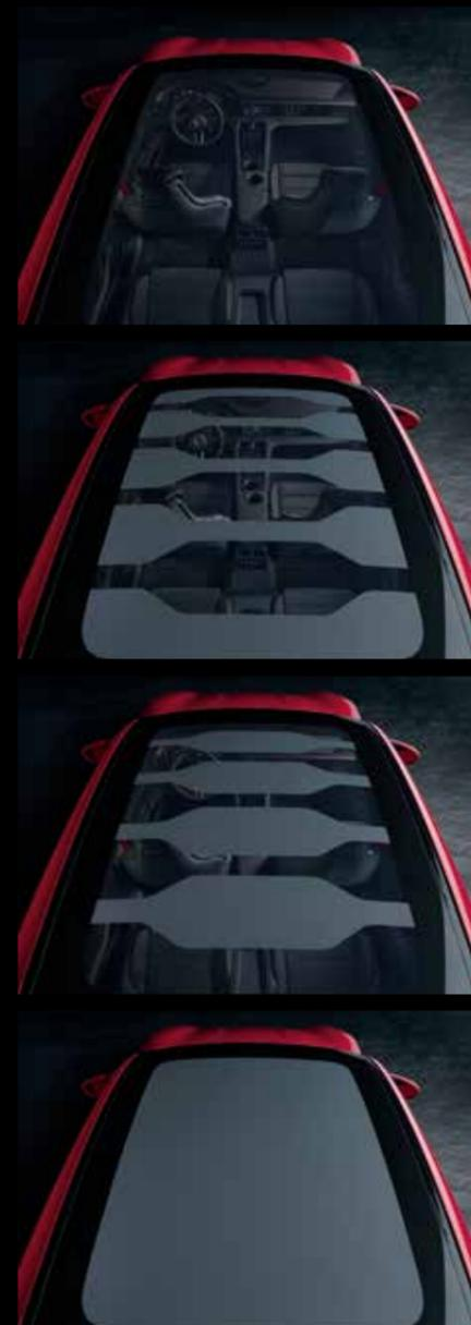
Bei der **PDLC-Technologie** (Polymer Dispersed Liquid Crystal) sitzen Flüssigkristalle in einer Folie. Über elektrische Kontakte werden sie mit Strom versorgt. Bei geringer Wechselspannung ordnen sich die Kristalle in Millisekunden so an, dass die Scheibe transparent wird. Wird das Glas hingegen von der Stromzufuhr getrennt, wechseln die Flüssigkristalle in einen ungeordneten Zustand. Folge: Die Scheibe wird matt.
