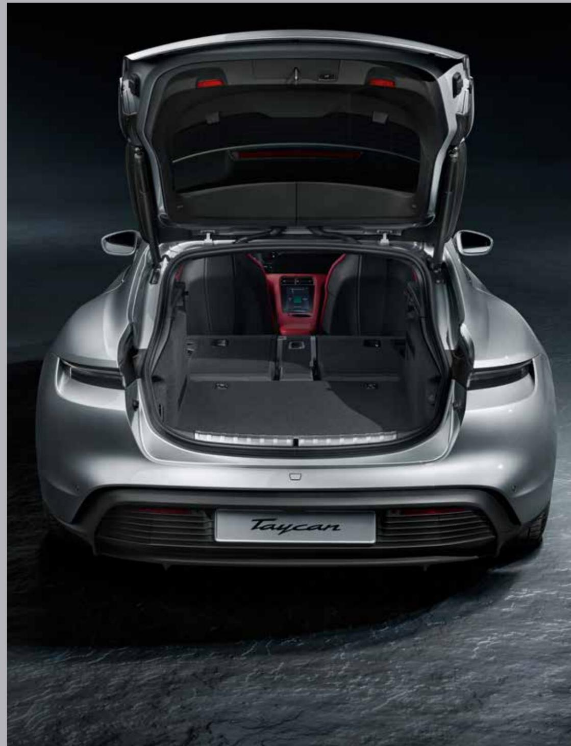
Die Öffnung der Heckklappe fällt mit 801 Millimetern wesentlich länger und mit 543 Millimetern deutlich höher aus als bei der Limousine (434 beziehungsweise 330 Millimeter).
